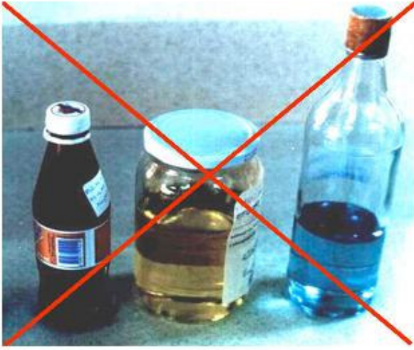
Şekil 2: Benzin ve motorin numunesi için kabul edilmeyen numune kapları
