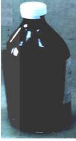
Şekil 1 : Standart sızdırmaz şişe (Benzin veya Motorin için)
