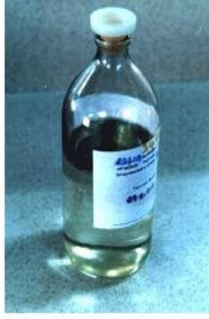
Şekil 1 : Standart sızdırmaz şişe (Benzin veya Motorin için)
